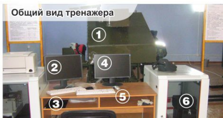
1 – модуль механика-водителя; 2 – монитор руководителя; 3 – клавиатура руководителя; 4 – монитор механика-водителя; 5 – клавиатура модуля механика-водителя; 6 – шкаф телекоммуникационный
